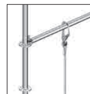
Fig. 11 Anhugningspunkter på Allround-horizontaler; feltlængde maksimalt 3,07 m
