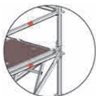
Fig. 84 Forbindelse af de vertikale søjler med sikringsstik
