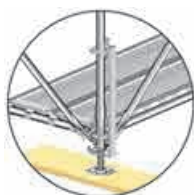
Fig. 83 Fodspindel-fastgørelse med kilehoved
