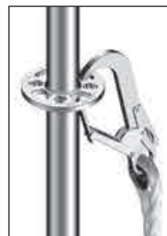
Fig. 10 Anhugning i det store og det lille hul i rosetten er mulig (Kun tilladt ved Allround-stillads af stål – ikke ved aluminium)
