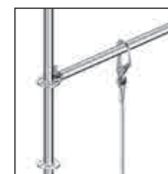
Fig. 11 Anhugningspunkter på Allround-horizontaler; feltlængde maksimalt 3,07 m
