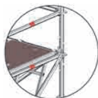
Fig. 85 Forbindelse af vertikale søjler med boltede horn
